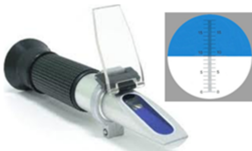
Figuur 3.11.: Refractometer en de aflezing daarvan.
