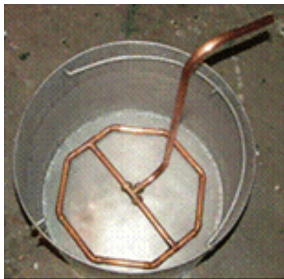
Figuur 3.5.: Koperen wortfilter met hevel.
